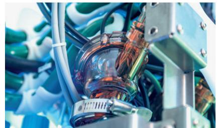
Délicat et fiable : Pendant la traite, le faisceau est libre et les gobelets, d'un poids idéal, compensent les mouvements de la vache, sans effort et sans effet de levier. Les capteurs de lait analysent le lait de chaque quartier pour en déterminer le niveau cellulaire, la conductivité, la colorimétrie, la température et la quantité. Ils n'acheminent que le lait consommable dans le tank de stockage.
