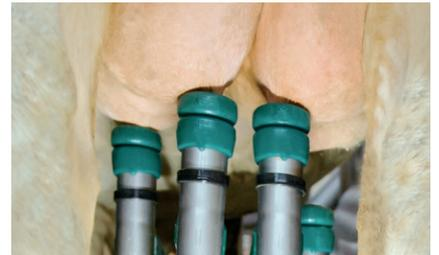
Sécurité hygiénique : Dès qu'un gobelet est en place, les trayons sont lavés et le pré-trempage peut alors être effectué conformément à la réglementation nationale. La traite des premiers jets commence dès la fin du séchage. Un système de capteurs démarre immédiatement l'analyse du lait et surveille la conductivité, la couleur et la température.
